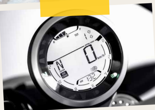
Индикаторы выключенной передачи и уровня топлива
